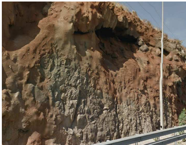
Cavidad en las coladas basálticas (desmonte de la autovía TF-1 a la altura de la salida 7)
